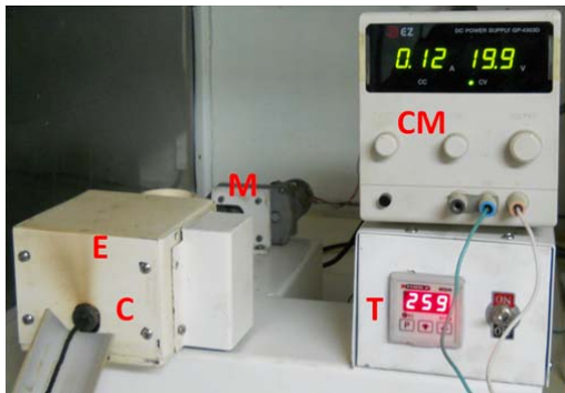
Figura 1. Extrusora semiautomática de laboratorio construida para la obtención del compuesto polímero-madera.
